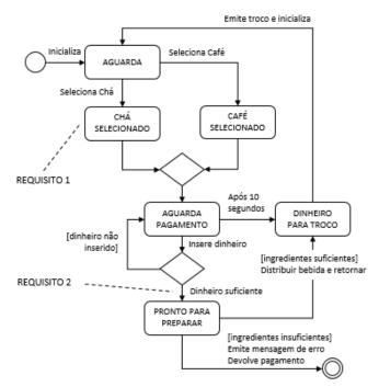
A figura ao lado (Figura 3) representa um exemplo de um modelo MBT desenvolvido com esta linguagem de modelagem. Mostra o comportamento de um distribuidor de bebidas contendo chá e café. Se o equipamento é ativado, a quantidade depositada é inicializada e está aguardando entradas do usuário. Estas entradas do utilizador podem ser "selecionar chá" ou "selecionar café" indicando a bebida desejada.
